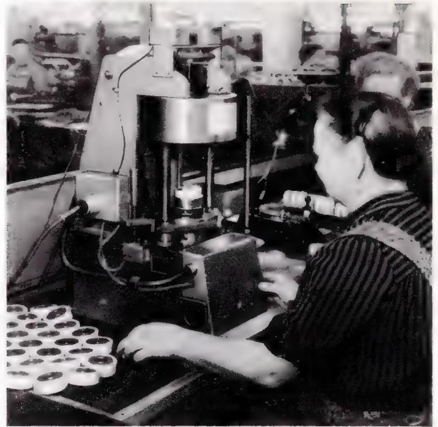
Bild 7. Magnetisieren der fertig montierten keramischen Magnetsysteme
