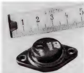
für Emitter und Basis ragen nach unten heraus, so daß sie in eine Novalröhrenfassung eingesteckt werden können. Die zulässige Verlustleistung beträgt 15 W bei einer Kühlfläche von 250 x 250 mm. Die maximal zulässigen Kollektor-Emitterspannungen liegen je nach Typ zwischen 12 und 50 V. Die neuen Leistungstransistoren ersetzen die bisherigen Typen CTP 1003 bis CTP 1006. Sie dienen zur Niederfrequenz-Endverstärkung, zur Schwin-
